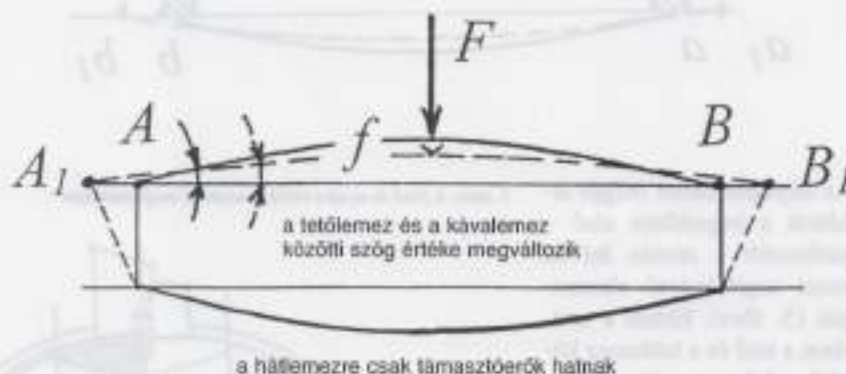
5. ábra: A hegedűtest alsó, legszélvesebb részén felvett metszet
